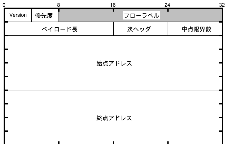
図 2 IPv6 のヘッダ形式
