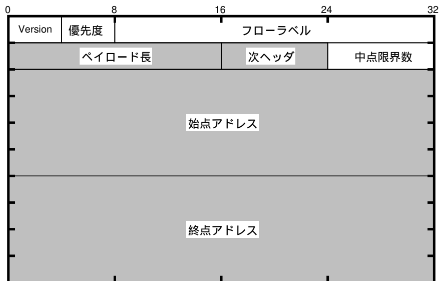
図 17 チェックサムの計算に使われるフィールド (IPv6)
